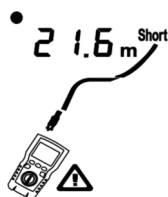
Abbildung 6.16 Kurzschluss auf Koaxialkabel
