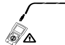
Abbildung 6.17 Spannung auf Koaxialverkabelung
